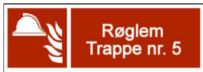
Figur 5.7.0.1.b: Eksempel på skiltning af røglem med undertekst.
