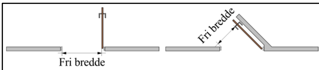
Figur 2.3.10 Måling af en dørs frie bredde ved henholdsvis en åbning på 90° og ved åbning på mindre end 90°.
