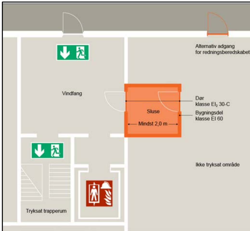
Figur 05.09.05: Sluse til vindfang for ATA-anlæg
